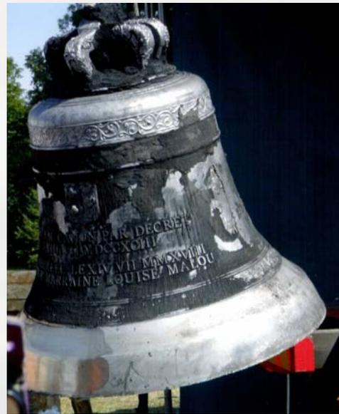
L'usure de la cloche actuelle encore en service est de 14,90 % ; à 15 %, elle doit être neutralisée. On imagine mal de plus entendre les sonneries familières.
