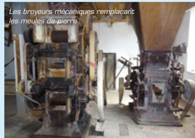
Les broyeurs mécaniques remplaçant les meules de pierre
